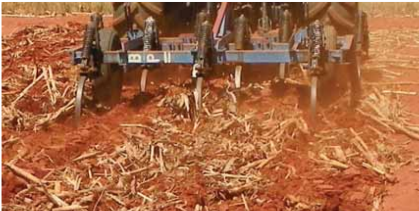
'n Beitelploeg waar die meeste van die oesreste op die oppervlak gelaat word, word as bewaringsbewerking beskou. Dit voldoen egter nie aan al die vereistes van bewaringsboerdery nie.
